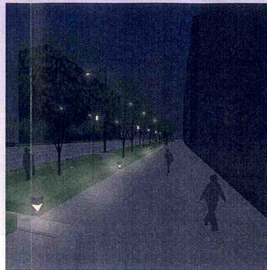
●道路照明イメージ図 歩道に柱式のもの あしより と足下灯を設け、車道用照明と合わせて、暖かみのある楽しい空間にします。
