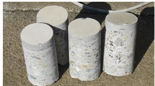
採取したコンクリートコア
